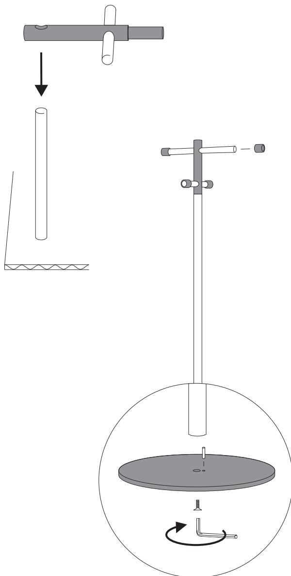
Zuerst den Metallstift in die kleine Bohrung der Bodenplatte einsetzen, dann das Standrohr mit der Grundplatte verschrauben. Die Schraube muss satt angezogen werden, damit sich das Rohr im Gebrauch nicht löst.
